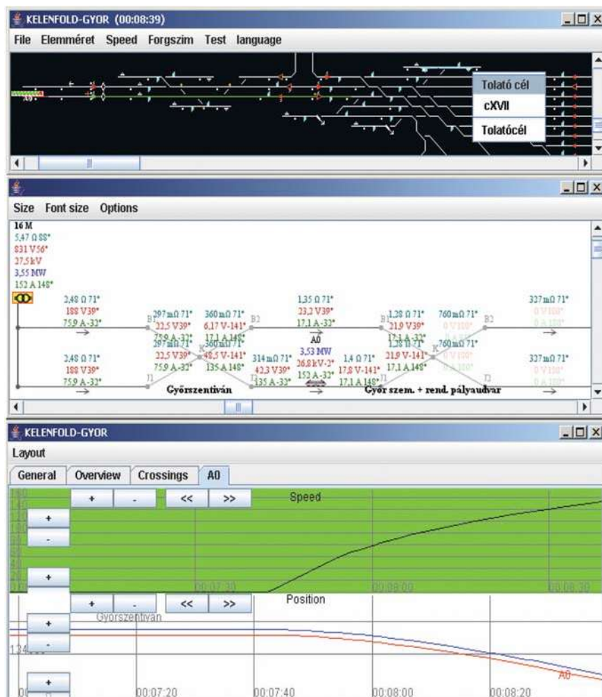
6. ábra: Ugyanaz a vonat a dinamikai, a bízter- és az erősáramú modulok megjelenítőin
