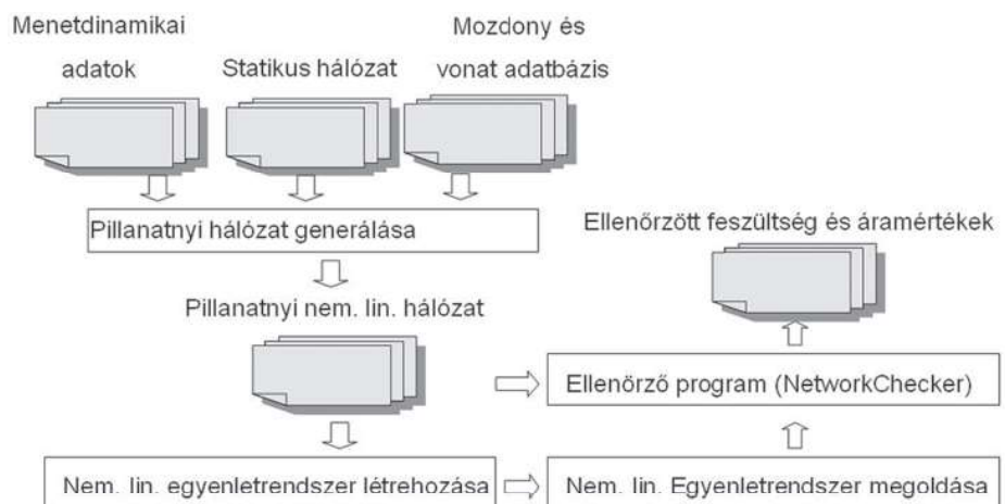
2. ábra: A nem lineáris felsővezetési hálózat számításának folyamata
